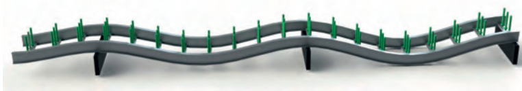
Determinação da CTA em múltiplos vãos (IEC 61537)
