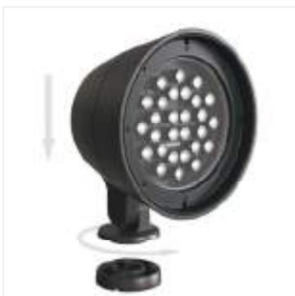
Sistema de montagem único: fixar a base sobre uma superfície ou um poste, inserir a parte macho e bloqueá-la rodando a luminária. Tudo apenas em duas etapas com um único operador.
