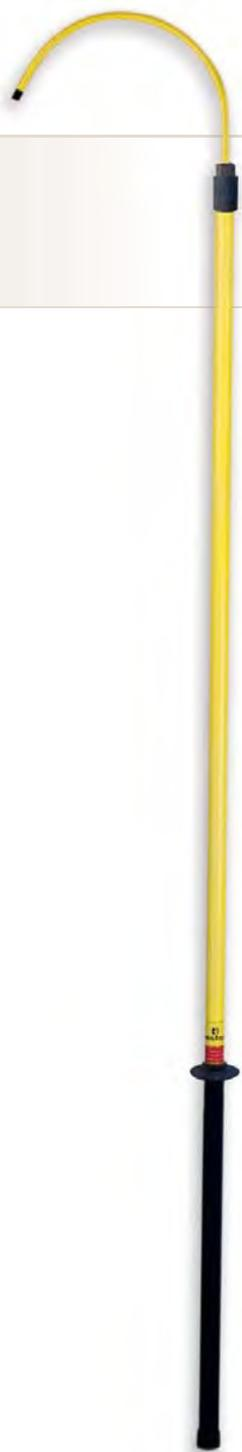
Varas de um único elemento, feitas com tubo de poliéster e fibra de vidro de Ø 32 mm. Com tampões anti-humidade em ambas as extremidades, protetor de mão, empunhadura, base, cabeça métrica M-10 e gancho de salvamento.
