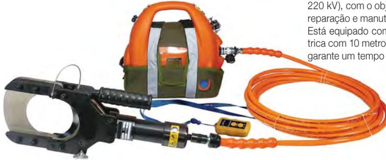
O kit isolado KH-120LV é adequado para cortar cabos de baixa, média e alta tensão que possam estar acidentalmente energizados (até 220 kV), com o objetivo de prevenir acidentes durante os trabalhos de reparação e manutenção.
