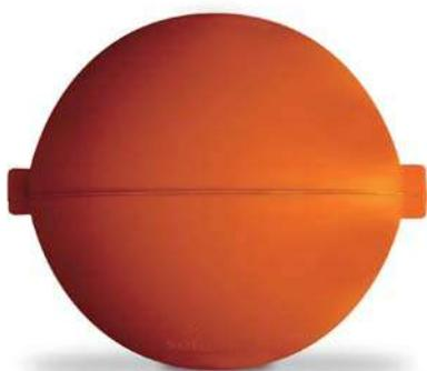
Esfera de sinalização diurna com fio para indicação e alerta às aeronaves e para prevenção de acidentes. O farol de sinalização é fabricado em polietileno com fibra de vidro e elevada resistência aos raios UV. Concebido com um baixo coeficiente aerodinâmico e com acessórios que permitem uma rápida montagem e ajuste, mesmo a partir de um helicóptero. Pode ser instalado em cabos sob tensão, cabos de proteção e cabos de fibra ótica.
