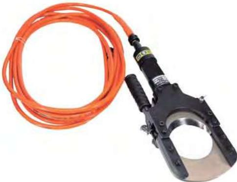
A cabeça CT-120M é adequada para cortar cabos sob tensão que possam estar acidentalmente energizados (até 220 kV), com o objetivo de prevenir acidentes durante os trabalhos de reparação e manutenção. Está equipada com uma mangueira flexível de alta capacidade dielétrica com 10 metros de comprimento.
