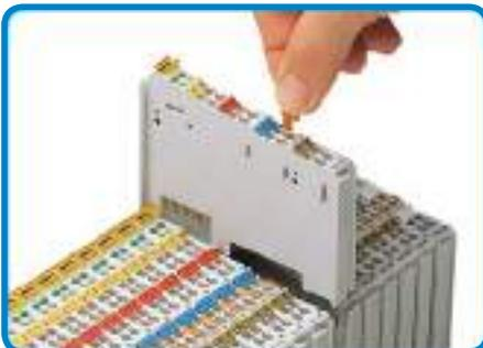
Troca rápida e sem ferramentas do módulo I/O com o nó montado.
