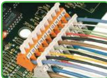
Possível disposição dos condutores em réguas de bornes com deslocamento (apenas para a Série 256).
