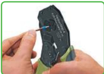
Introduza o condutor equipado com ponteira na unidade de cravação.
