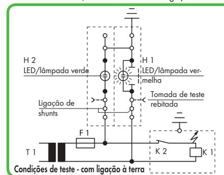
Seccionador aberto, circuito auxiliar sem ligação à terra, LED vermelho aceso.
