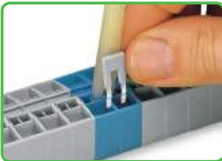
Interligação com barras de shunts para interligação.
