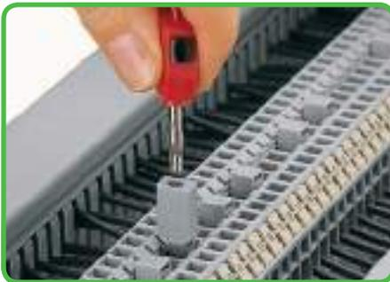
Teste com adaptador para teste.
