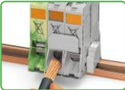
Insira o condutor descarnado (respeite o comprimento a descarnar de 35 mm) na unidade de fixação até atingir o batente. Mantenha esta posição.
