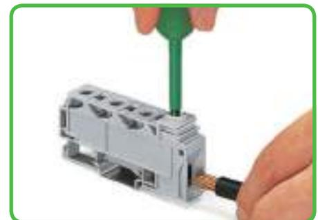
Terminação de um condutor de 35 mm<sup>2</sup>/AWG 2
