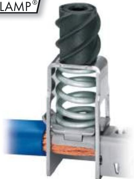
A tecnologia da conexão POWER CAGE CLAMP é adequada para todos os tipos de condutores, desde 10 a 4/0 AWG (6-95mm<sup>2</sup>). O condutor conectado é fixado a uma gaiola dupla constituída por um suporte com fixação por mola e uma barra de corrente com formato em U.
