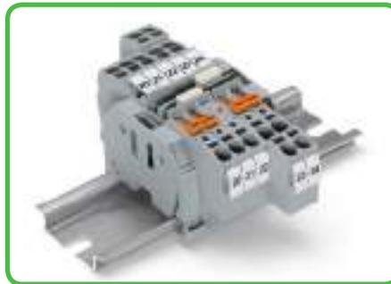
Ranuras de shunt duplas, na mesma posição dos bornes da Série 2002. Opções de ligação na parte frontal ou traseira da desconexão da faca, dependendo da direcção da alimentação de energia. Ranuras de identificador uma central e duas laterais para identificadores WMB ou fitas de identificação.
