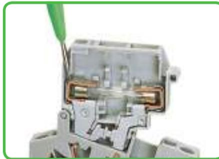
Teste de tensão, tanto na entrada como na saída com o suporte do fusível na posição fechada (sob tensão).
