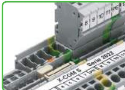
Ligação dos bornes base através do shunt multi-funções. Empurre o shunt para baixo até ficar totalmente inserido!
