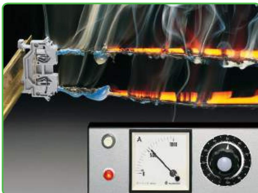
Simulação de um borne montado em calha de 12 AWG (4mm<sup>2</sup>) equipado com CAGE CLAMP®. **Aumento da corrente sem limite de tempo.** Neste teste em condições extremas - normalmente os dispositivos fusíveis teriam interrompido a corrente) - **a ligação eléctrica permaneceu sem danos.**
