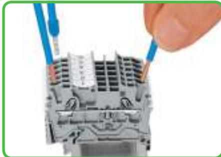
Terminação de encaixe rápido: Os condutores rígidos com secções nominais de um tamanho acima ou dois tamanhos abaixo, podem ser empurrados directamente para dentro – sem ferramentas.
