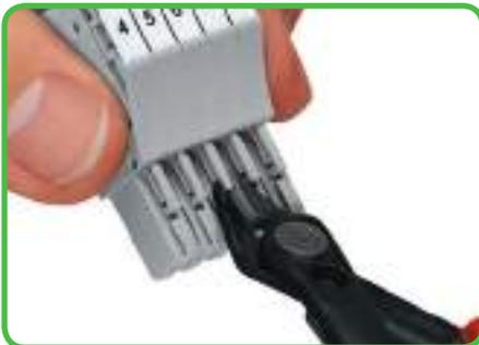
Codificação de uma ficha fêmea: remova o pino codificador utilizando uma ferramenta adequada.
