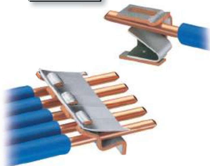
A tecnologia PUSH WIRE® é perfeitamente adequada para uma conexão rápida dos condutores rígidos. Esta tecnologia utiliza a rigidez do condutor para proporcionar uma introdução directa e segura na unidade de fixação.
