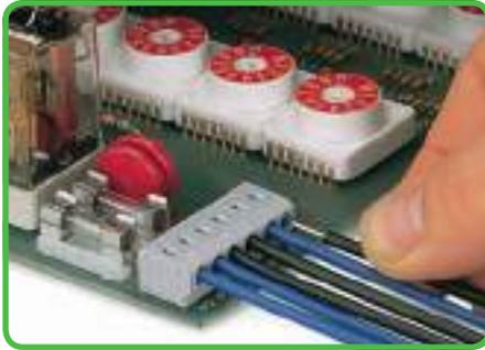
Insira o condutor rígido através da terminação de encaixe. Régua de bornes sem botões de pressão.
