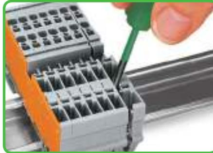
Desbloqueie o conjunto com uma chave de fendas (3,5 x 0,5) mm e remova o borne utilizando a alavanca de libertação.
