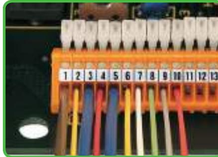
Secção nominal 0,5 mm<sup>2</sup>/AWG 20; 0,75 mm<sup>2</sup>/AWG 18 somente em qualquer outra posição.
