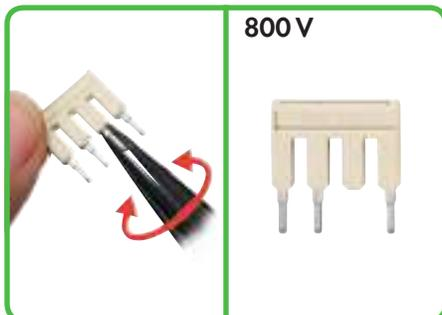
Os contactos do shunt desnecessários podem ser partidos e removidos, a parte superior do shunt pode ser, em seguida, identificada em conformidade. Aplicável às Séries 2001, 2002 e 2004.
