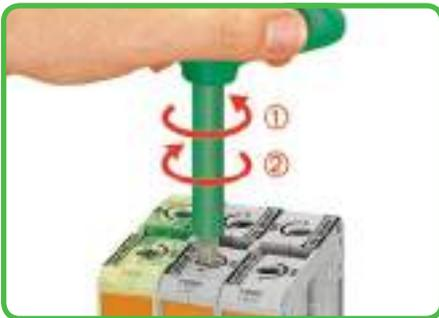
Desbloqueie a alavanca com uma breve rotação da chave sextavada no sentido contrário ao dos ponteiros do relógio ①. Depois de desbloqueada (clique), aguarde que a chave sextavada rode no sentido contrário ao dos ponteiros do relógio (automático) ② para terminar o condutor de forma segura.
