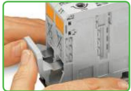
Interligação com shunt adjacente: introdução do shunt, sem utilização de ferramentas, em cima do orifício de entrada do condutor. A secção nominal mantém-se em 50 mm<sup>2</sup>/AWG 2/0 e 95 mm<sup>2</sup>/AWG 4/0.
