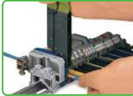
A ferramenta é colocada na ranhura superior do borne com entrada lateral e a abraçadeira é encaixada na ranhura lateral. O contacto fica totalmente aberto através da pressão dos punhos até que eles encostem. Insira o condutor descarnado até atingir o batente.
