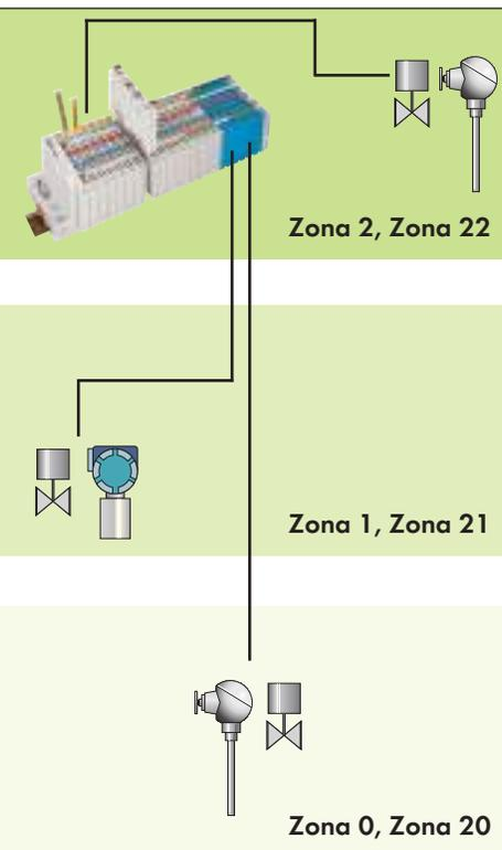
O WAGO-I/O-SYSTEM 750 foi aprovado para ser utilizado nas zonas de risco Zona 2. O sistema permite também a ligação directa aos sensores/actuadores das Zonas 0 e 1.
