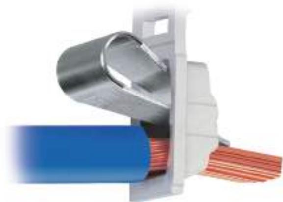
A tecnologia CAGE CLAMP®S apresenta a mesma qualidade e funcionalidades de manuseamento que a conexão CAGE CLAMP®, no entanto, com uma vantagem adicional: os condutores rígidos e semi-rígidos, bem como os condutores flexíveis com ponteiros podem ser conectados de forma directa, sem usar ferramentas. Para tal basta empurrar o condutor até ficar totalmente inserido, sem ter que abrir previamente a unidade de fixação.
