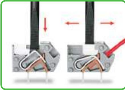
Terminação do condutor: Para abrir momentaneamente a unidade de fixação use a chave de fendas e insira o condutor descarnado. Para abrir a unidade de fixação por um período longo, desloque a patilha de bloqueio na direcção do orifício de entrada do condutor. Em seguida, insira todo o condutor descarnado e desloque a patilha de bloqueio para trás, até à sua posição original (também se pode fazer com a unha do dedo).
