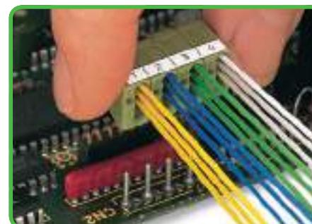
Remover régua de bornes das placas de circuito impresso modulares para substituir o quadro.
