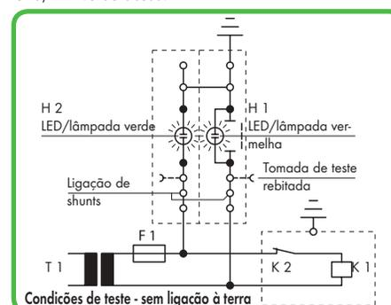
Seccionador aberto, circuito auxiliar sem ligação à terra.
