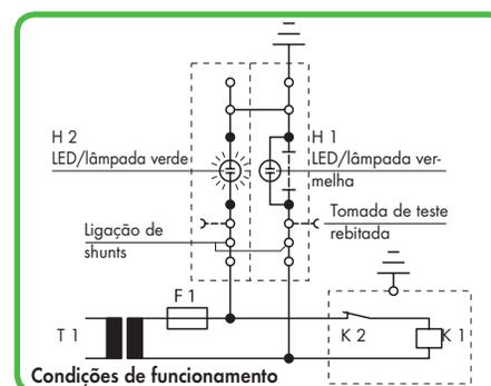
Seccionador fechado, circuito auxiliar com ligação à terra, LED verde aceso.
