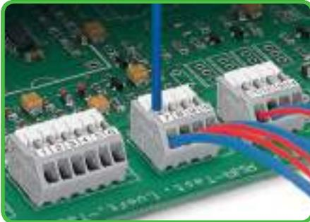
Teste realizado directamente na mola de fixação. Marcação com fitas de identificação auto-adesivas.
