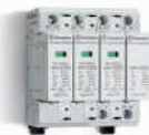
Tipo 7P.04.8.275.1012 DPS Tipo I+II para sistema TT (TN- S) trifásico com Neutro. Proteção a varistor + centelhador (GDT)L1, L2, L3-N + centelhador N-PE
